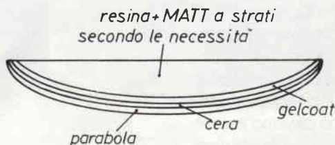
Preparazione dello stampo partendo da una parabola normale.
